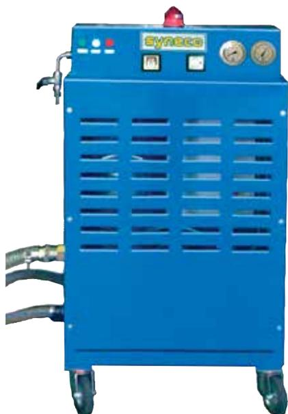
L'unità di filtrazione **ALWAYS CLEAN**, costituita da un gruppo motopompa e un filtro, viene installata in ricircolo al serbatoio esistente.
